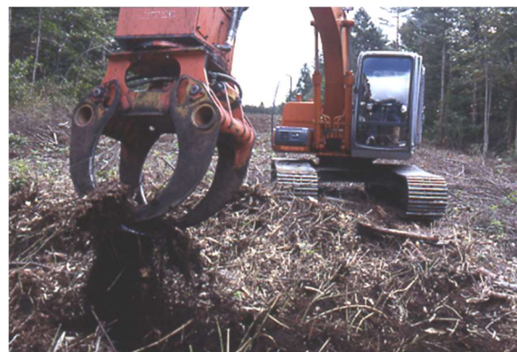
処理A：グラップルでササ地下茎をつかみ、掘り上げる。ササのないところではグラップルでA層まで掘り返す。
