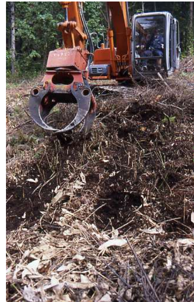
処理B：グラップルを地表に擦りつけて落葉・腐植層(L・F)を剥ぎ取る
